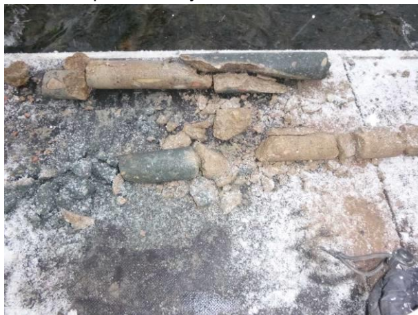
Líc zdi je kamenný obklad zaspárovaný cementovou maltou. Pokračuje betonová část proložená kamenem.
