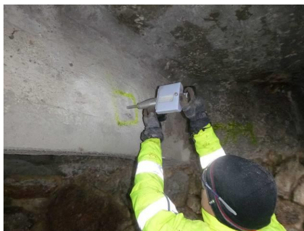
Pohled na nedestruktivní zkoušení pevnosti betonu.
