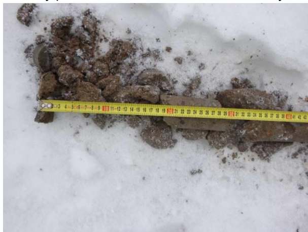
Pohled na počátek vývrtu, kde prvních 20 cm je kamenný obklad, následuje skladba betonu proložená kamenem.
