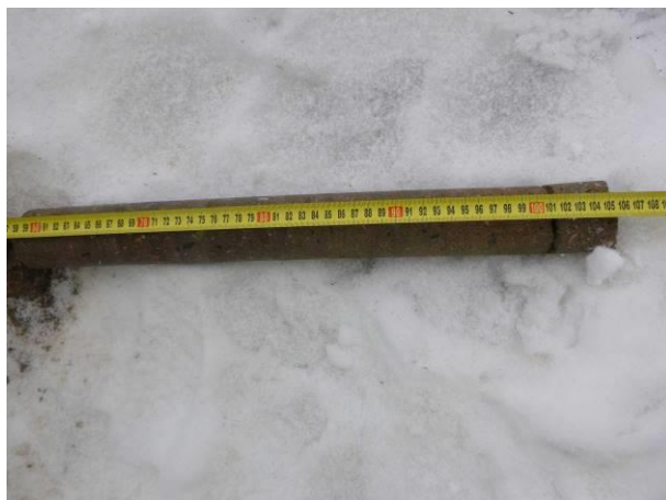
Pohled na část 70 – 105 cm. Viditelná celistvá struktura betonu.
