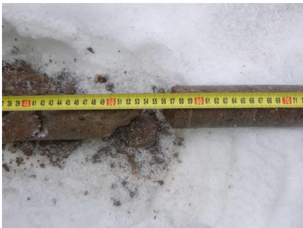
Pohled na prostřední část v tloušťce 40 – 70 cm. Viditelná struktura betonu.
