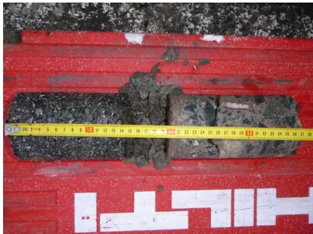
Pohled na vývrt V4. Viditelné asfaltové souvrství (obrus + podklad), násyp a následuje železobetonová deska.
