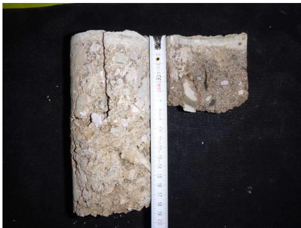
Pohled na polorozpadlý vývrt V1 odebraný z krajního trámu.
