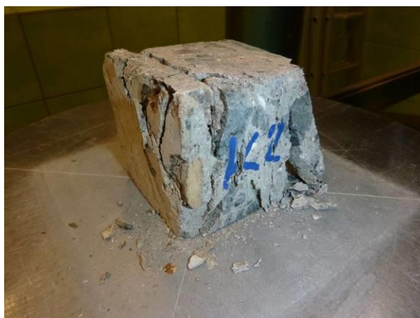
Pohled na vzorek po destruktivní zkoušce pevnosti betonu v tlaku.
