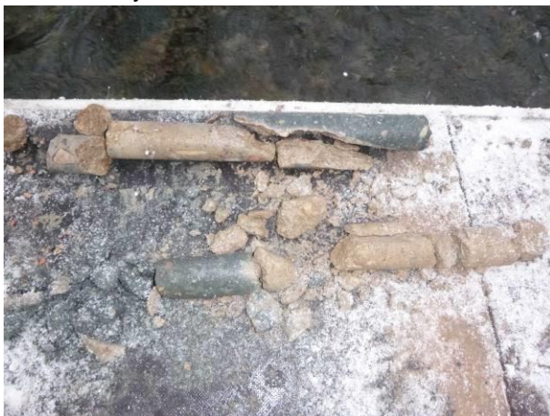
Celková tloušťka byla ve vývrtu V3 naměřená 1,10 m.
