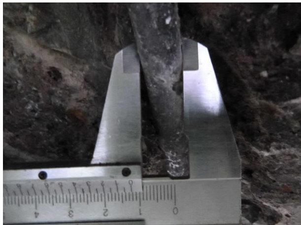
Hladká (10 216), Ø 12 mm ě 180 mm, povrchová koroze.
