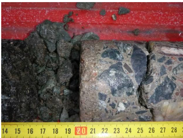
Hydroizolace nebyla detekována.
