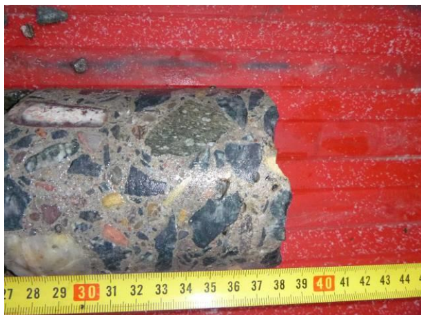
Pohled na vymytý cementový tmel mezi kamenivem. Beton je špatné kvality.
